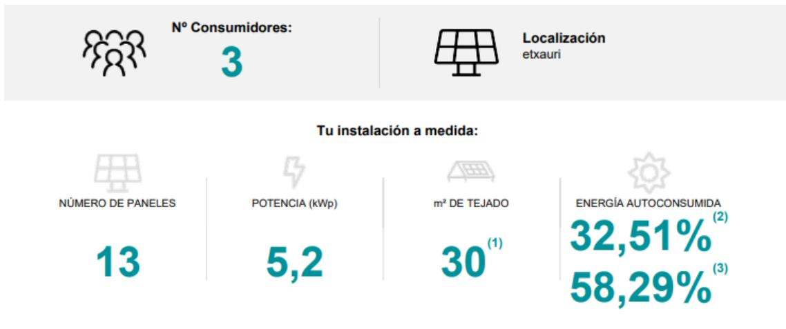
Con una potencia unitaria de 400 Wp, un módulo solar de 144 (6x24) células, se han distribuido 13 módulos con una **potencia punta agregada de 5,2 kWp**.
